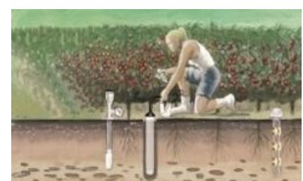
I [lisimetri a suzione](#) sono strumenti in grado di prelevare la soluzione circolante del terreno. Il principio di funzionamento è molto semplice, rapido ed efficiente
