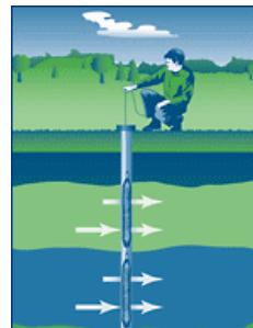
Il [campionatore a diffusione passiva](#) consiste in una vescica di materiale semipermeabile, riempita con acqua deionizzata, e stabilizzata con una zavorra
